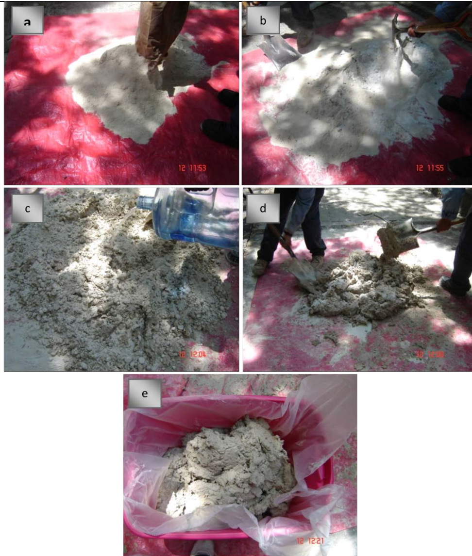
Figura 5.2. Conformación del suelo artificial: a) colocación de los materiales secos (arena, limo, arcilla y materia orgánica), b) mezclado de los materiales, c) adición de agua destilada al suelo artificial para igualar humedad, d) mezclado de los materiales, e) almacenamiento del suelo conformado.
