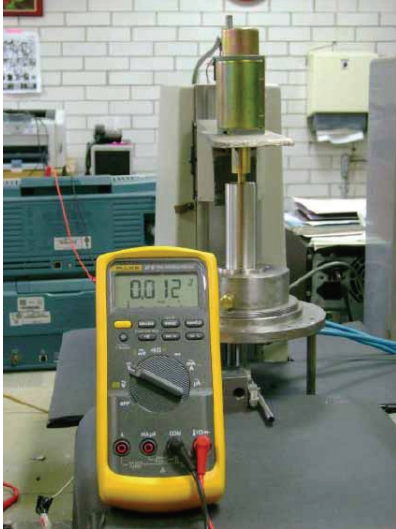
Figura I-3 Foto de archivo: prueba del viscosímetro.
