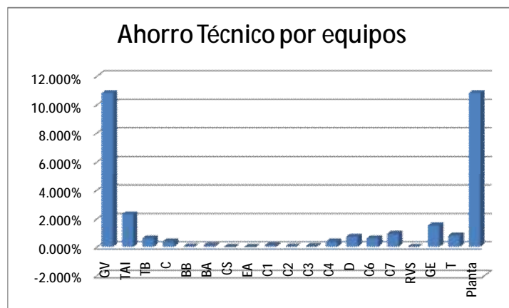
Gráfica 6. 1 Ahorro Técnico por equipos para 50% de la potencia total de la planta.
