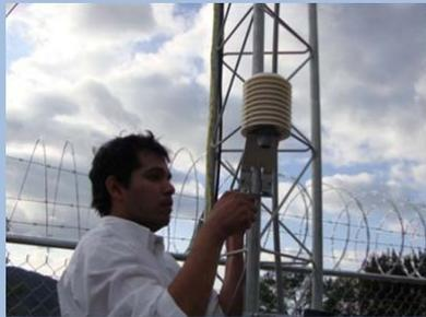
Fijación de sensor de temperatura y humedad relativa del aire.
