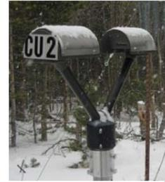
Ilustración 23: Sensor óptico de precipitación
