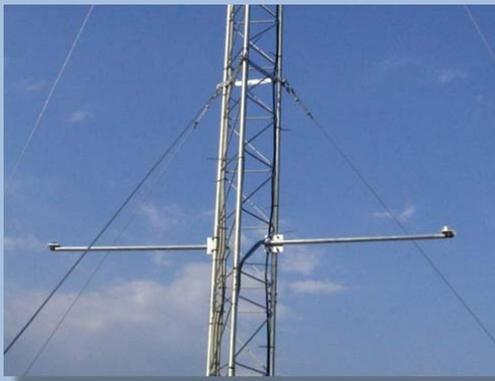
Fijación y orientación de antena GPS y Sensor de Radiación Solar.
