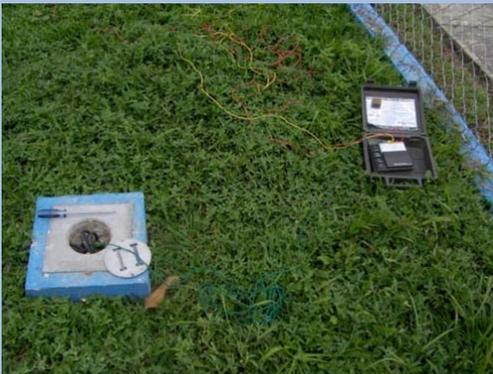
Medición de resistencia del suelo.
