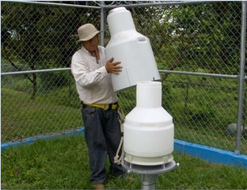
Colocación y nivelación del sensor de precipitación.
