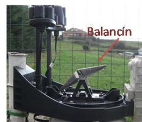
Ilustración 21: Pluviómetro tipo balancín
