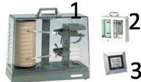
Ilustración 18: Tipos de higrómetros
