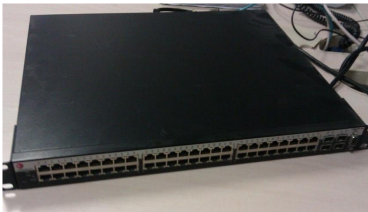
Figura 5.1.4 Switch de enlace entre los relevadores
