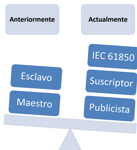
Figura 3.9 Arquitecturas de red más usadas en subestaciones
