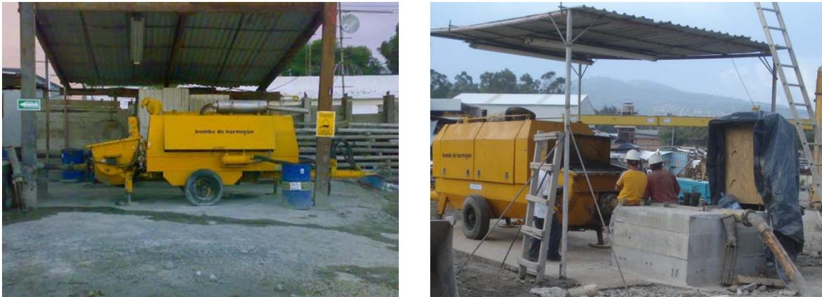
**Fig. 4.2.12 Bomba para transporte de concreto al sitio de colocación**
