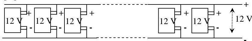
Figura 31 Configuración de la conexión de las baterías para 12 [V]
