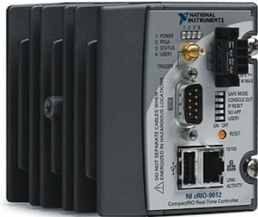
Figura 3.2. NI cRIO 9012 (MCU de tiempo real).
