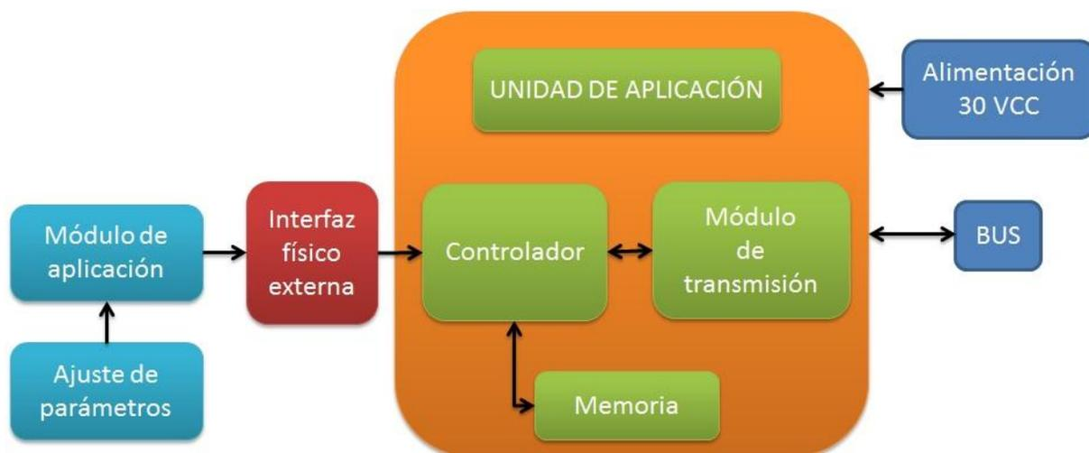
**Figura 4.15. Diagrama de bloques del detector de movimiento.**
