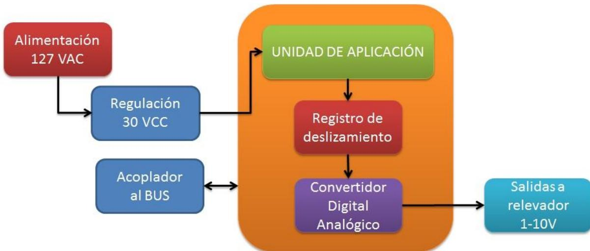
**Figura 4.11. Diagrama de bloques regulador de luminosidad.**
