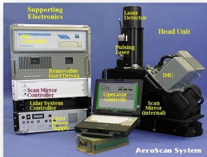
Figura 1.1.2 El sistema LiDAR AeroScan con componentes marcados.
