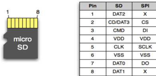
Figura 2.34. Distribución de terminales de la memoria micro SD.
