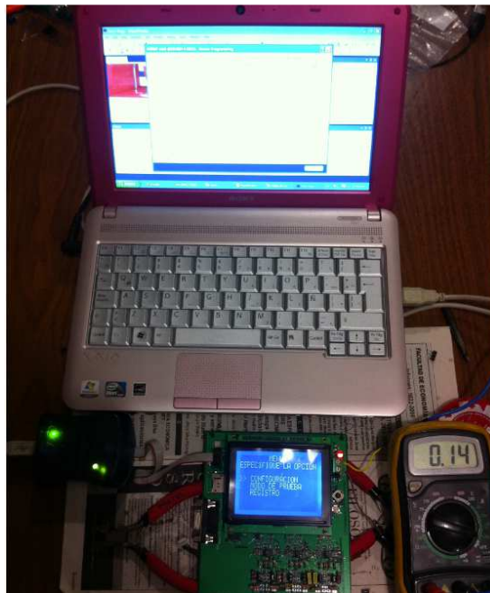
Figura 4.7. Conexión entre el programador, la PC y el DIGI.
