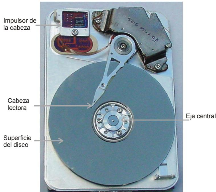
Figura. 2.1 Elementos que componen a un disco duro.
