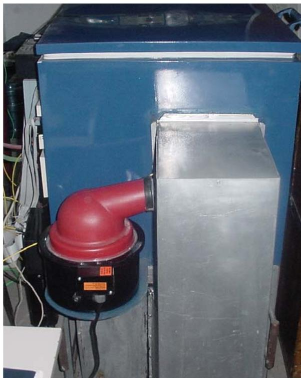
**Figura 4.7** Se muestra la ubicación del humidificador, que proporciona la humedad a través de un ducto de la cámara de corrosión.
