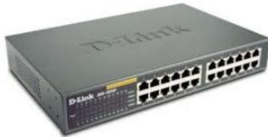
Figura 3.36 – Switch con 24 puertos
