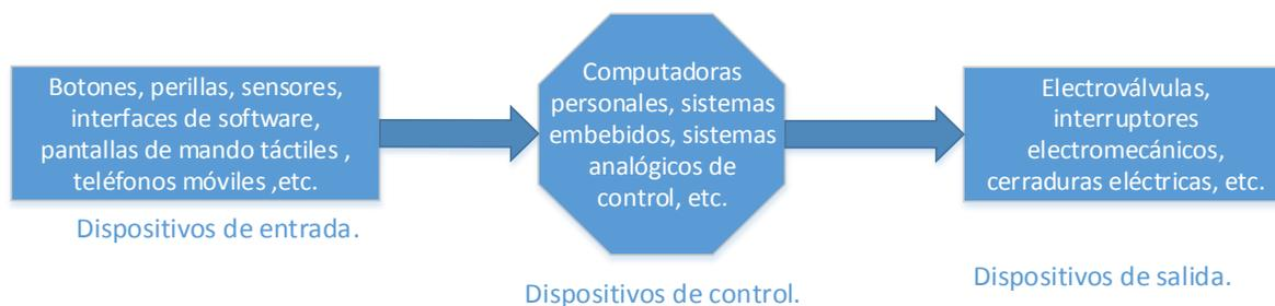
**Ilustración 1.2: Elementos de un sistema domótico y ejemplos.**
