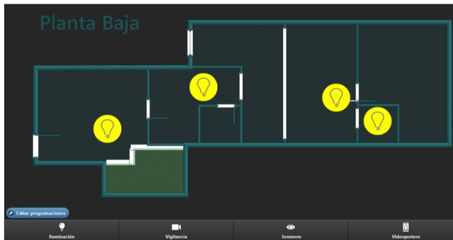
**Ilustración 6.4:** Pantalla del módulo de control y automatización de iluminación de la interfaz.
