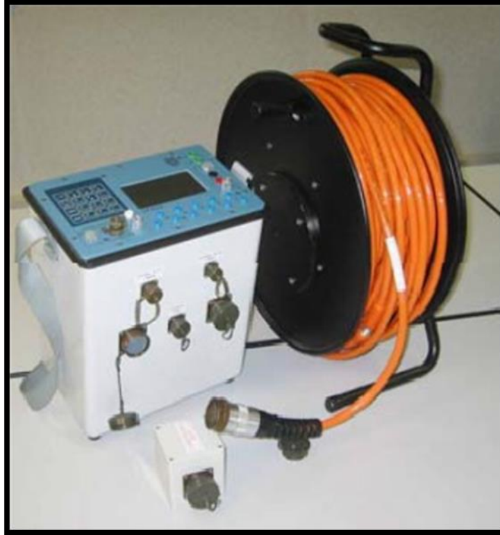
Figura 3.1 Resistivímetro SYSCAL Pro Switch y cable multi-core.
