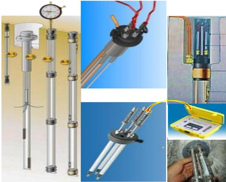
Fig. II.6 Extensómetros de barras rígidas.
