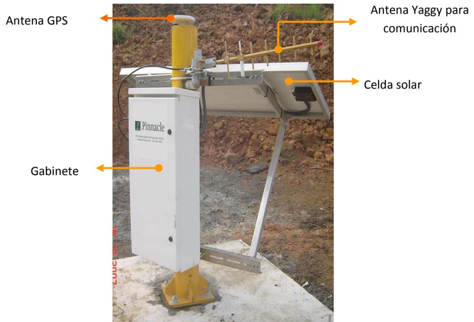
Fig. 2.2 Estaciones GPS utilizadas para el monitoreo en tiempo real.
