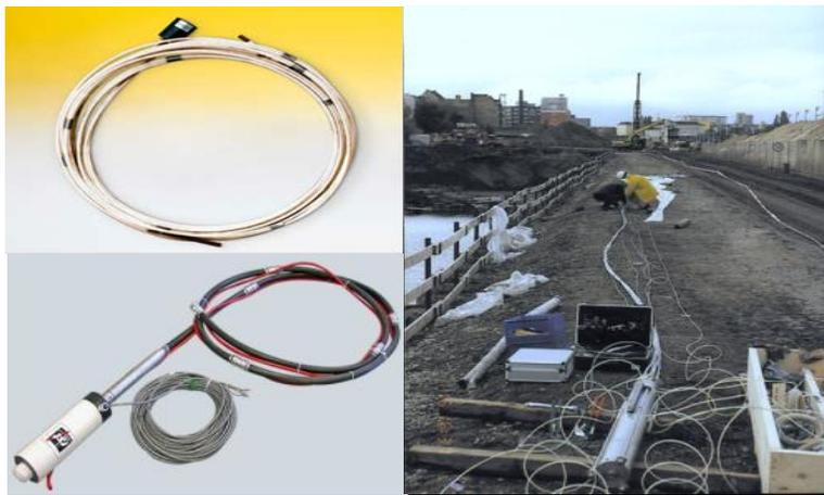
Fig II.7 Extensómetros de barras flexibles
