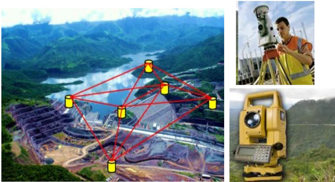
Fig. II.15 Red de triangulación y equipo para la medición
