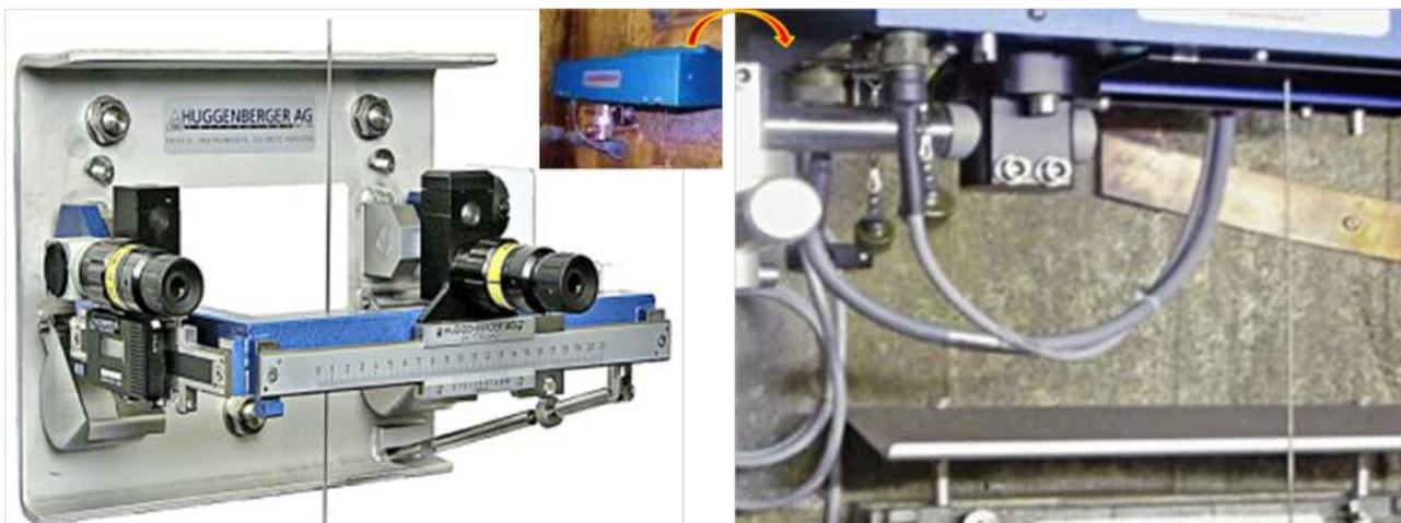
Fig. II.2 Tipos de instrumento de medición: plomada o péndulo
