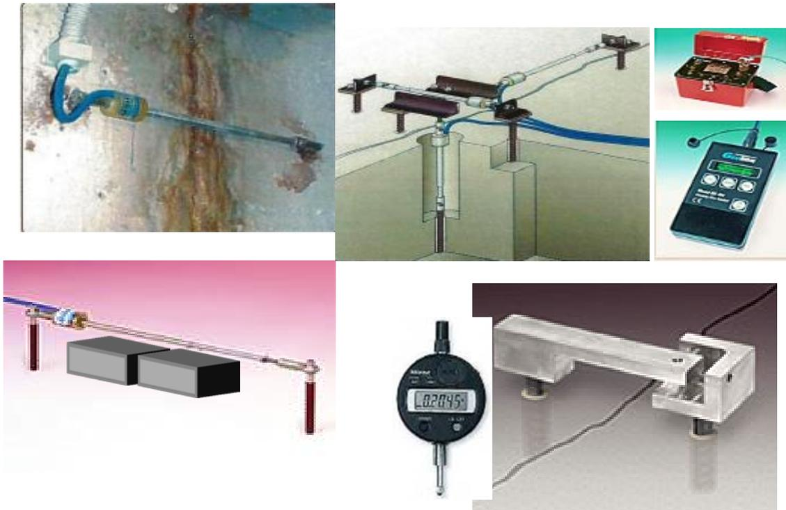
Fig. II.11 Medidores de Junta de tipo eléctricos y mecánicos
