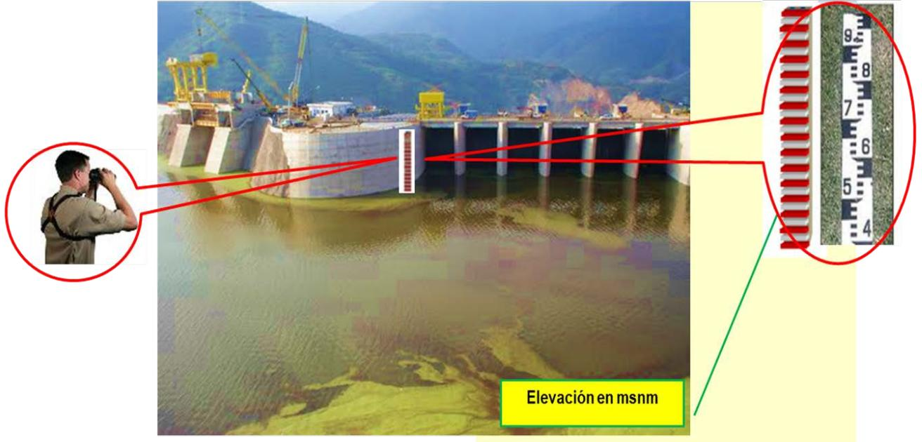
Fig. II.25 Medidor de Nivel de Embalse. Lecturas manuales.
