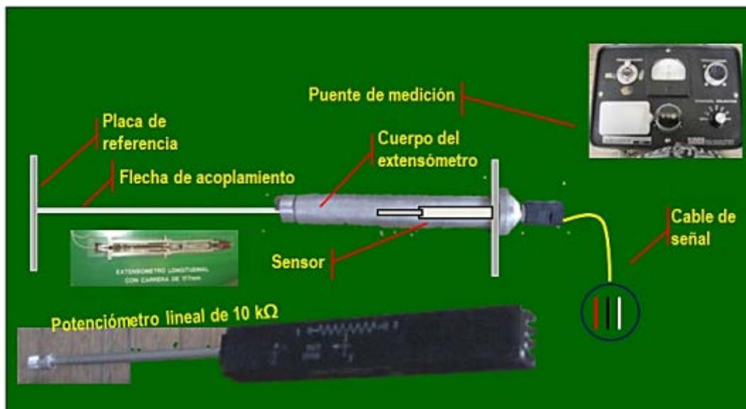
Fig. II.9 Extensómetro de placas utilizado anteriormente en instrumentación de Presas en México, desarrollado por el Instituto de Ingeniería de la UNAM y la CFE
