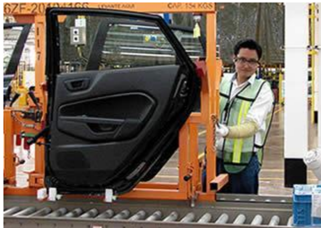
Figura 29 Empleado realiza montaje de una puerta sobre un cuadro de metal.
