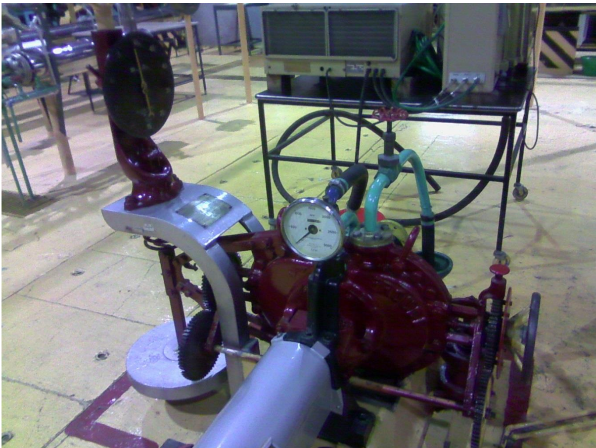
Figura 17 Freno de Froude Facultad de Ingeniería UNAM
