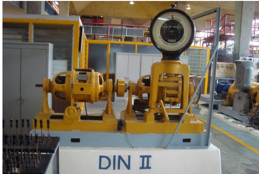
Figura 12 Banco de pruebas de motores eléctricos Laboratorio de máquinas eléctricas.
