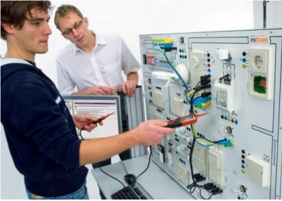
Figura 41 Consola modular de instrumentos electrónicos y eléctricos.
