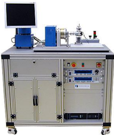
Figura 42 Banco de pruebas horizontal para motores de baja potencia.
