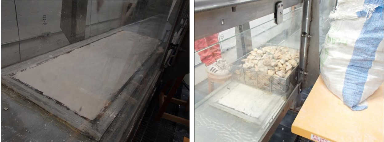
Fig.4.18 Colocación del material (suelo) en el cajón y de la cimentación de la estructura
