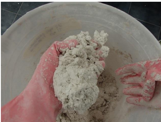
Fig.4.17 Mezcla del material en seco con la proporción de agua correspondiente
