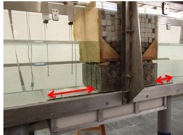
Fig.4.23 Ubicación de la estructura sobre el suelo así como su colocación antes y después de verter agua en el canal
