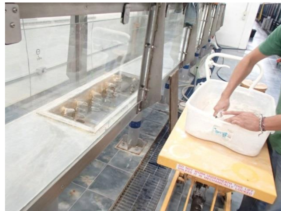
Fig.4.17 Mezcla del material en seco con la proporción de agua correspondiente
