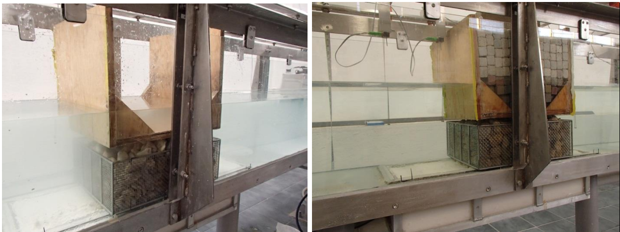
Fig.4.19 Distribución de cubos dentro del cajón de madera
