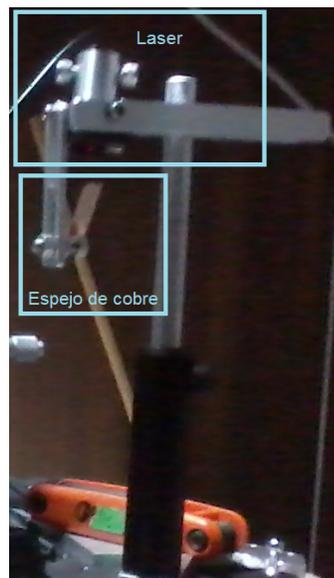
Figura 3.5: Estructura con láser y espejo de cobre.
