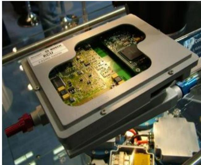
Figura 2.11. Unidad de control completa para un auto F1, KCU. (ref.18).
