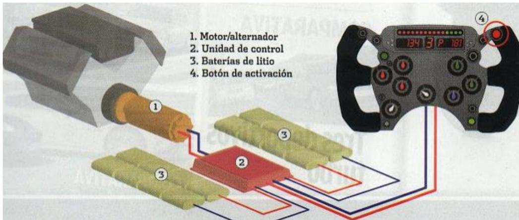
Figura 2.12. Esquema de la conexión del motor-generator. (ref.19)
