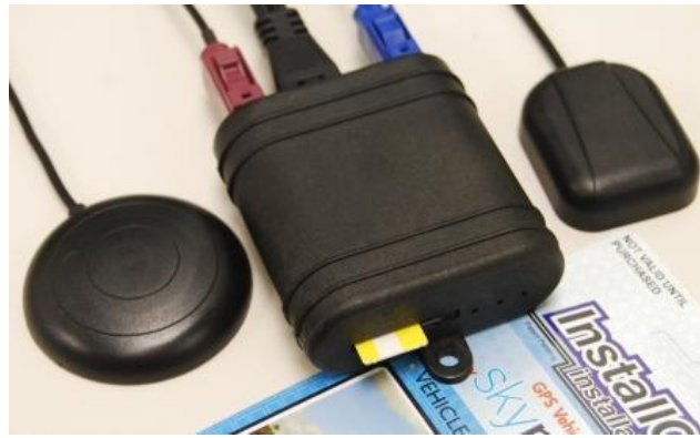
Figura 3.1 H: Dispositivo GPS TT8750 con antenas y SIM.
