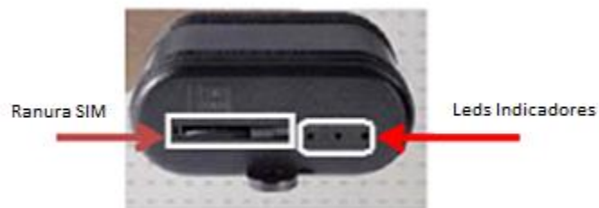
Figura 3.1 F: Dispositivo GPS TT8750, con vista de frente.
