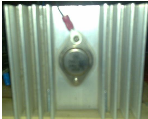
Figura 2.6 F: Circuito físico transistor de potencia.
