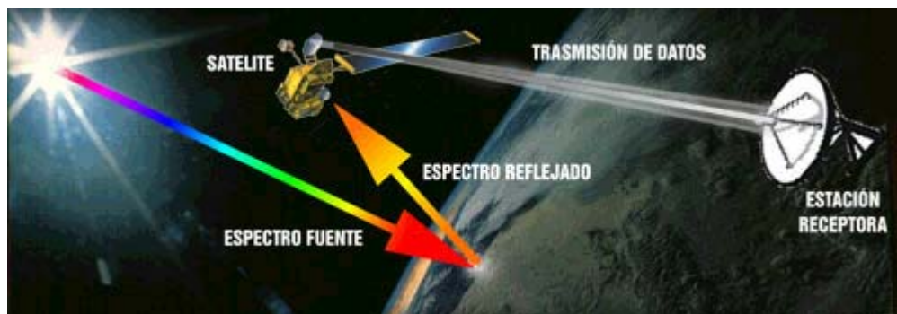
Figura 2.1 El esquema operativo de un satélite de observación
