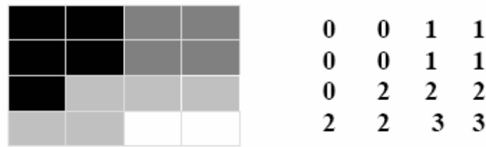
Figura 4.1 Imagen prueba u original donde los valores corresponden a niveles de grises
