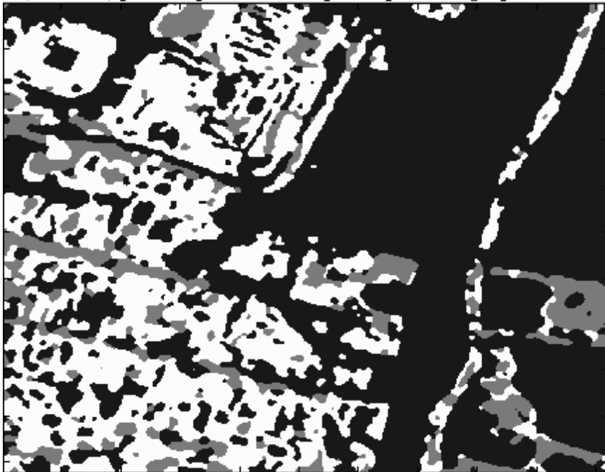
Figura 7.22 Resultado para 60 iteraciones imagen en colores falsos del algoritmo de recocido simulado, en esta imagen los puntos producto de la aleatoriedad de clases casi han desaparecido en un 100 %, visualizando una imagen segmentada en clases (recocida) pero no precisa en lo que respecta a agrupamiento
