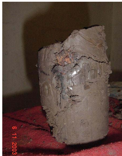
Fotografía 3.2.4. Muestra 3, se observa que en la parte superior central se encontró un trozo de madera atrapado en el suelo, y además se extrajo la muestra incompleta
