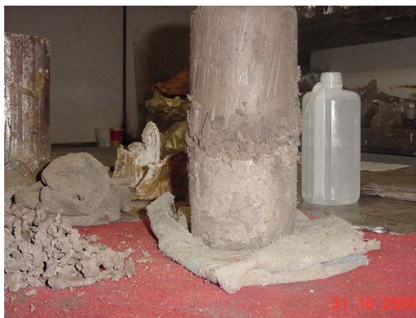
Fotografía 3.2.3. Muestra 2, se aprecia el contacto entre los dos tipos de suelo donde hay cambio de estratigrafía
