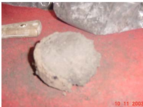
Fotografía 3.2.5. Muestra 4 no se pudo extraer un segmento grande inalterado, todo salió en trozos pequeños como éste
