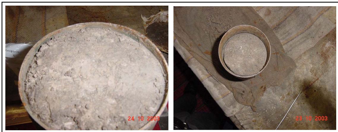
Figura 3.2.3. Procedimiento de labrado de las muestras para sacarlas del tubo
