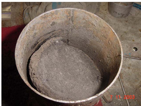
Fotografía 3.2.6. Se trata también de la muestra 4, como se observa el contacto entre dos tipos de material el oscuro que es arenoso (con asfalto-debido a lo superficial de la extracción) y el otro arcilloso
