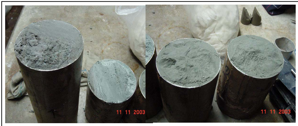
Fotografía 3.2.7. Tubos con el suelo contaminado al momento de ser cortado en secciones
