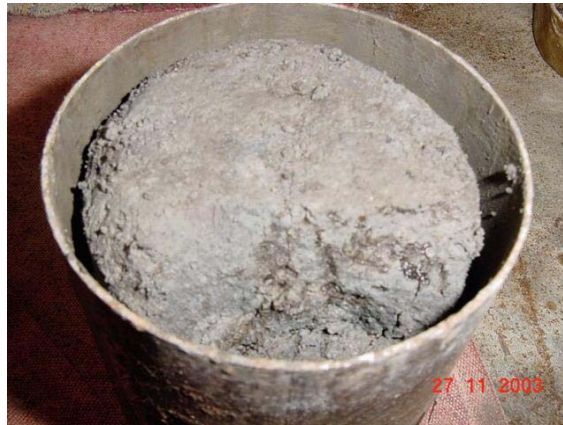
Fotografía 3.2.10. Muestra 3 se localizan las manchas, y cambios en la coloración del suelo por el contaminante
