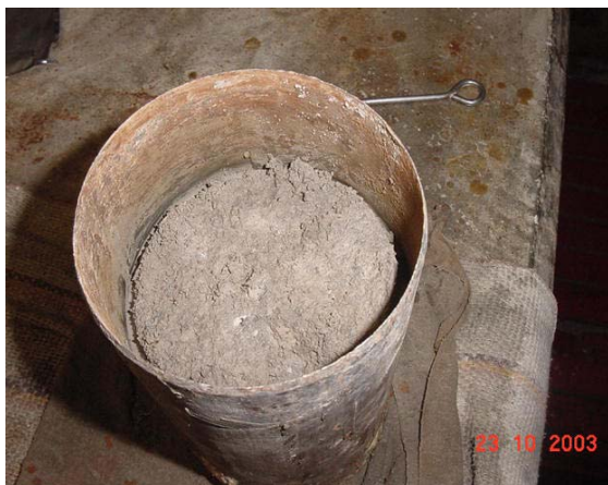
Fotografía 3.2.1. Muestra 1, se aprecian las condiciones del tubo y la forma en se realizó el labrado de la muestra
