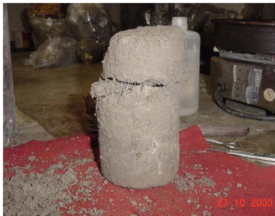
Fotografía 3.2.2. Muestra 1, se observa la ruptura del segmento en el momento de la extracción, además su tendencia a desmoronarse
