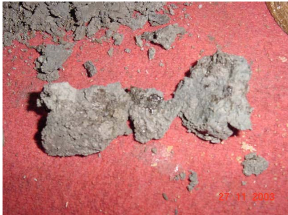
Fotografía 3.2.9. Se observan algunas concentraciones de aceite desprendidos de la muestra 3
