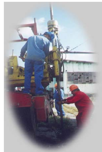
Figura 3.2.1 . Equipo para la extracción de las muestras a) Trípode, hincado de tubo de muestreo a impacto b) Perforadora, trabaja con motor y broca de perforación.
