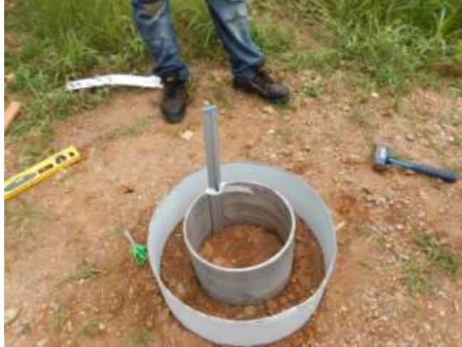
Figura 3.1.4 Montaje final del infiltrómetro.
