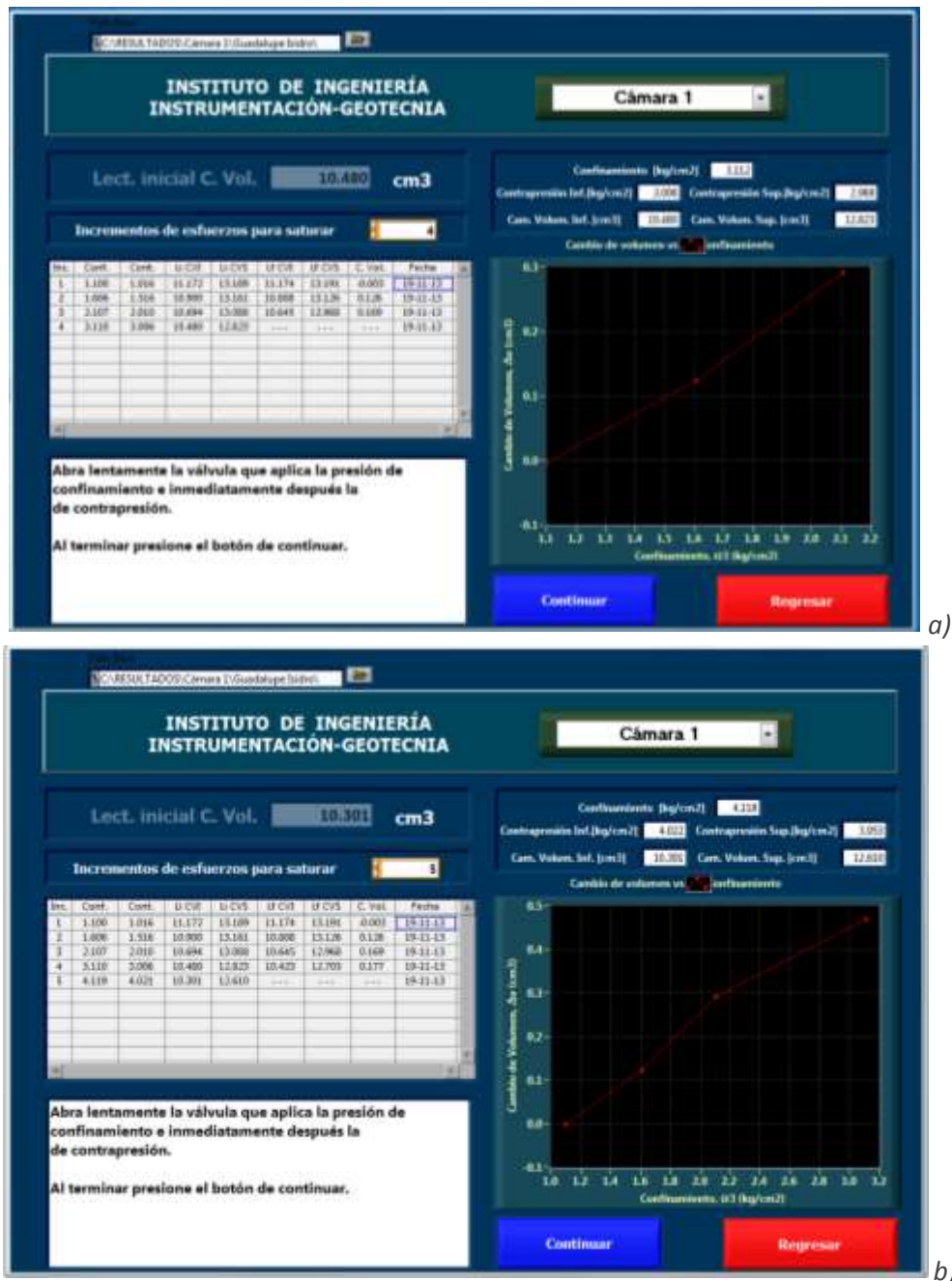
Figura 3.2.13 Saturación por contrapresión en pastilla #16, aplicando una presión de confinamiento a) 3.112 \text{ kg/cm}^2 y b) 4.118 \text{ kg/cm}^2 .
