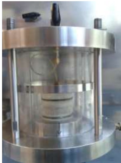
Figura 3.2.12 Montaje de la pastilla en la cámara.
