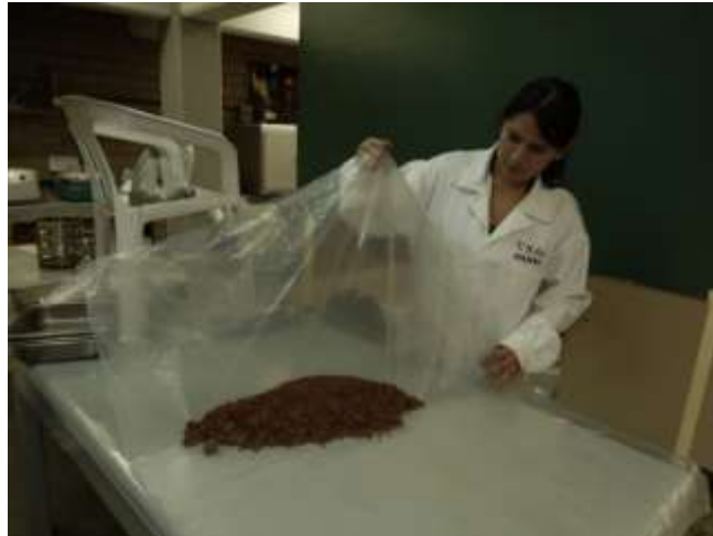
Figura 3.3.2 Proceso de homogeneización a la muestra de suelo INF-3
