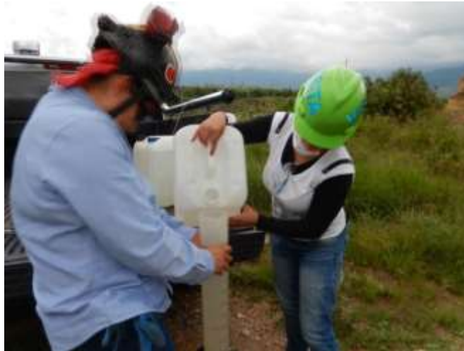
Figura 3.1.5 Medición exacta del volumen de agua a introducir al anillo interior.
