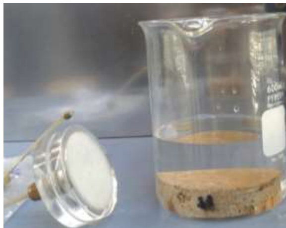
Figura 3.2.10 “Saturación” de la pastilla #16 durante 24 horas.
