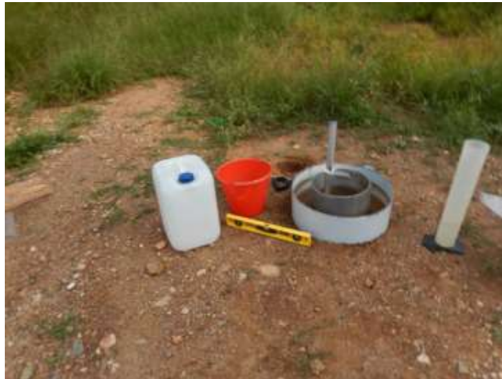
Figura 3.1.1 Equipo utilizado en la prueba de infiltración en campo
