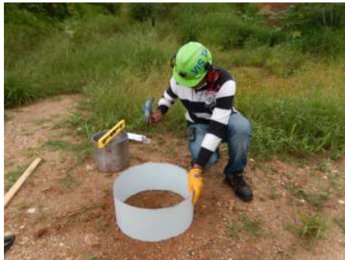
Figura 3.1.3 Anillo exterior hincado al suelo a 15 cm de profundidad.
