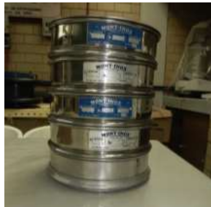
Figura 3.3.4 Algunos tamices utilizados para la prueba de granulometría
