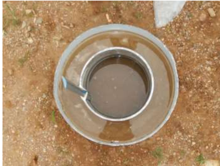
Figura 4.1.1 Prueba de infiltración en INF-1
