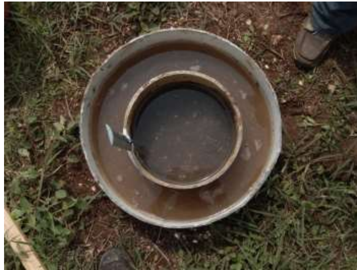
Figura 4.1.5 Prueba de infiltración en INF-3
