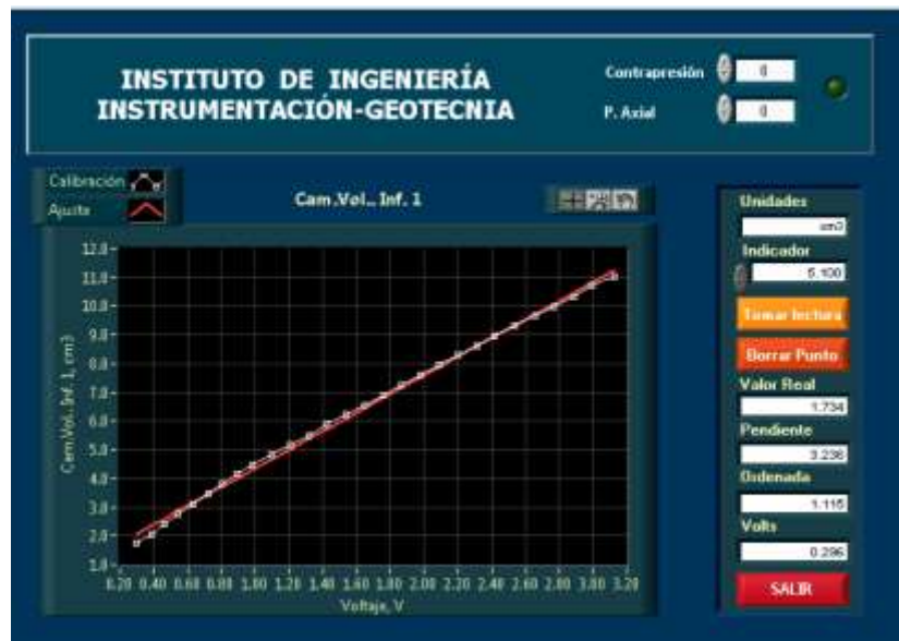
Figura 3.2.7 Pantalla de la gráfica para calibración (sensor de cambio volumétrico inferior).
