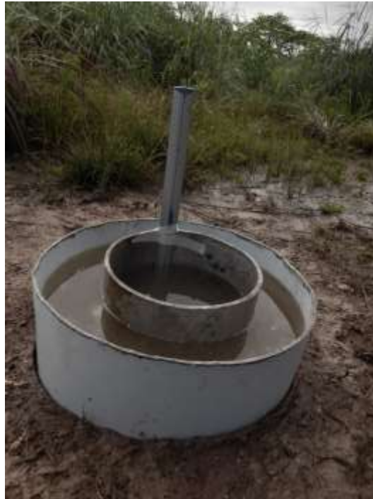
Figura 4.1.3 Prueba de infiltración INF-2
