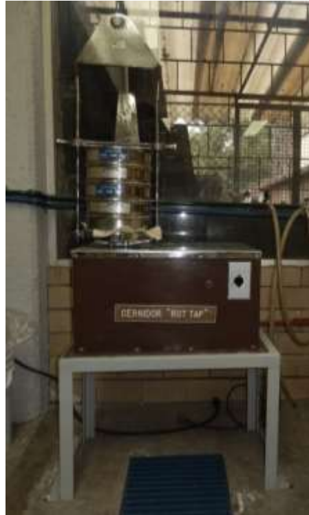
Figura 3.3.5 Primer juego de tamices montado en el cernidor "Rot Tap"
