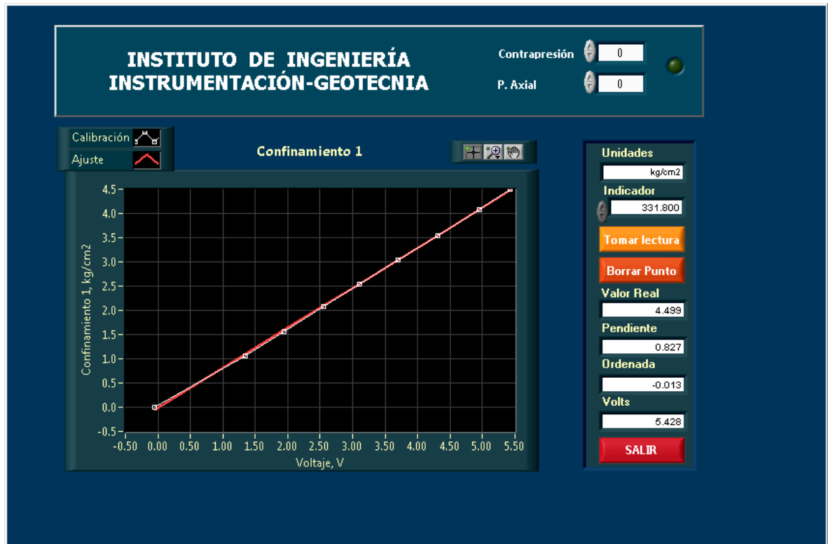
Figura 3.2.5 Pantalla de la gráfica para calibración (sensor de confinamiento).
