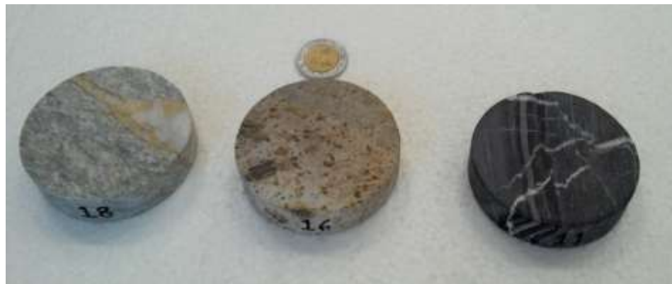
Figura 3.2.8 Pastillas de rocas obtenidas a partir de barrenos.
