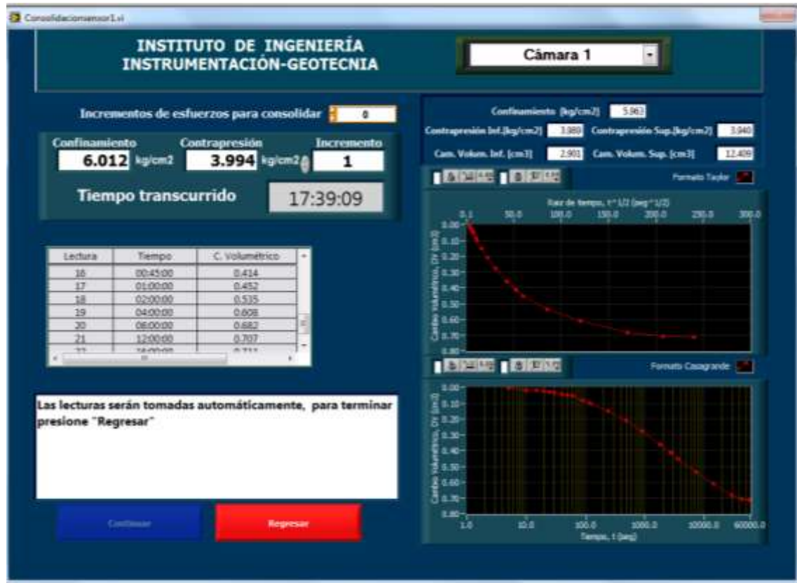
Figura 3.2.15 Consolidación de la pastilla #16 en un tiempo transcurrido de a) 14 horas, 10 minutos b) 15 horas, 33 minutos y 23 segundos y c) 17 horas, 39 minutos y 09 segundos.
