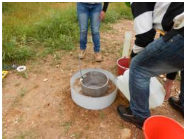
Figura 3.1.6 Vaciando un volumen de agua a los anillos.
