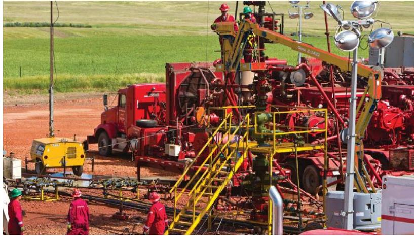
Figura IV. 4 Equipo de Halliburton para Fracturamiento Hidráulico.
