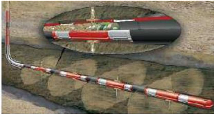
*Figura IV.6 Esquema de fracturamiento en la formación.*
