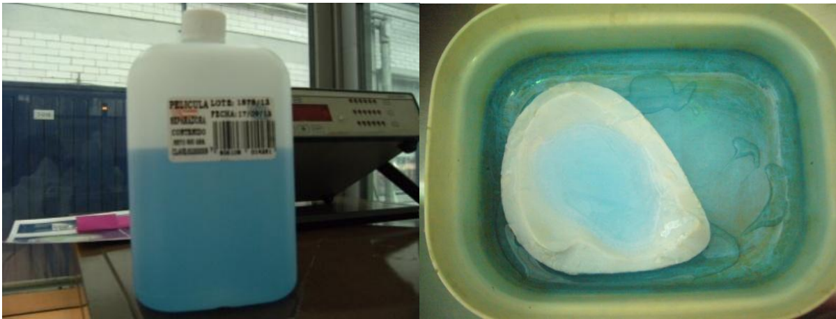
Figura 34 Recubrimiento del molde con PVA
