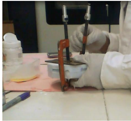
Figura 37 Empaque del PMMA en el molde con las prensas
