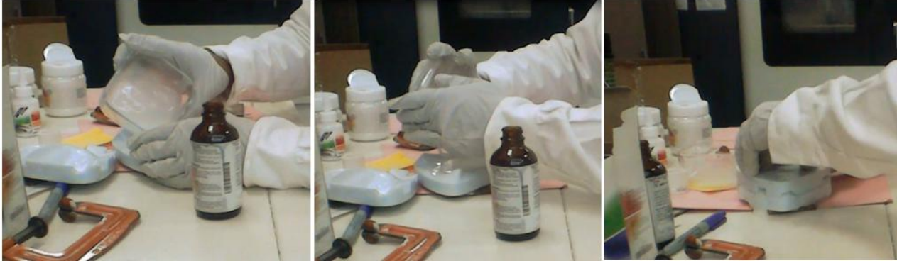
Figura 36 Empacamiento del PMMA en el molde
