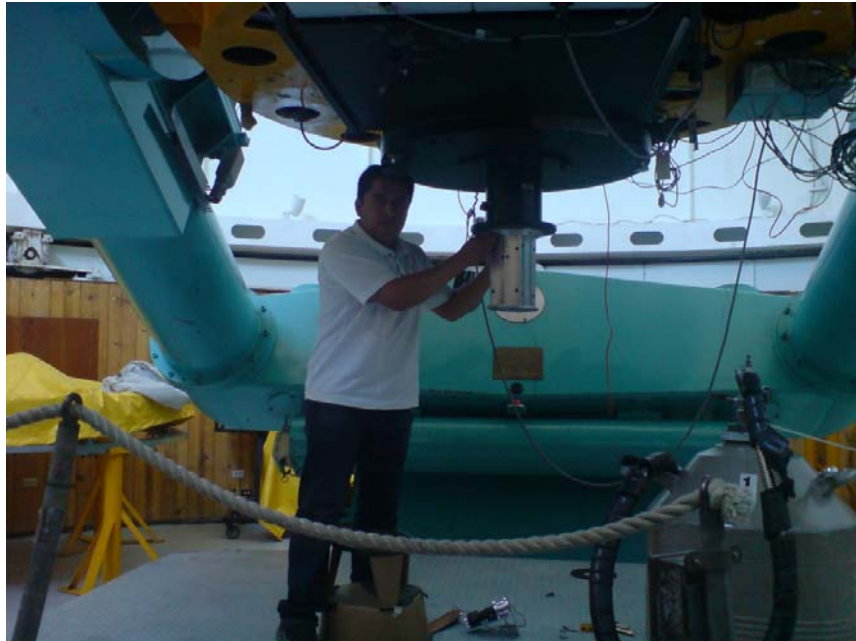
Imagen 4-10 Instalación del Interferómetro de Motas en el telescopio.
