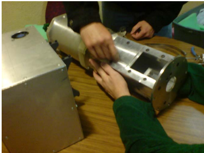
Imagen 4-11 Tohtli con cámara CCD enfriada por nitrógeno líquido.
