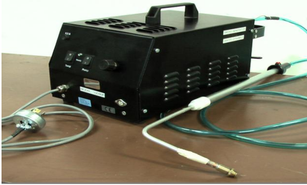
Figura 2.10 Generador de humo.
