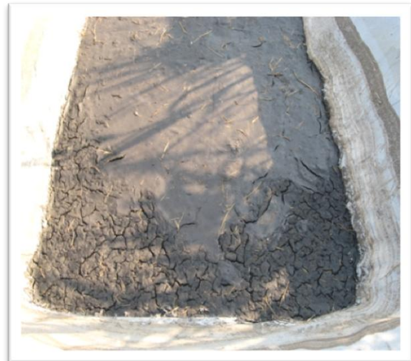
Figura 4.10: Fotografía del lodo acumulado en la celda C
