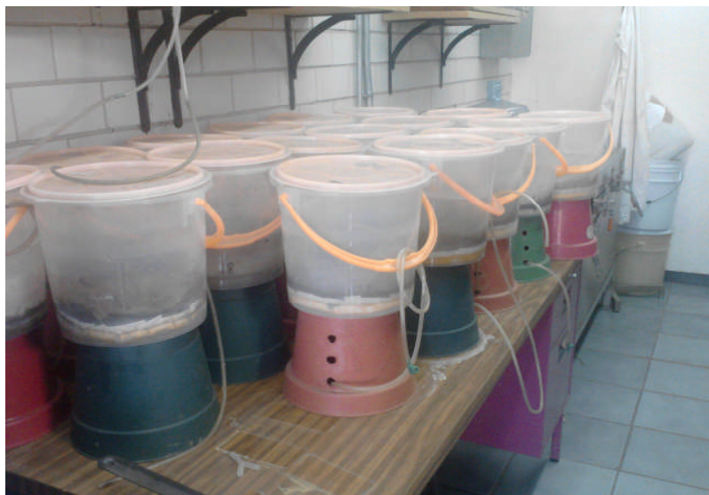
Figura 3.5 Sistema de 16 celdas de humedad empacadas con jal intemperizado mezclado
