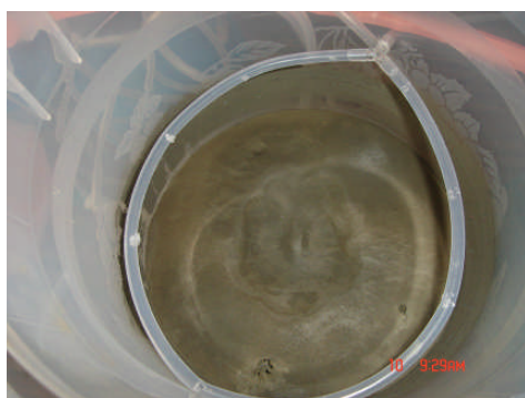
Figura A- 1.2 Interior de celda con jal y difusor de aire
