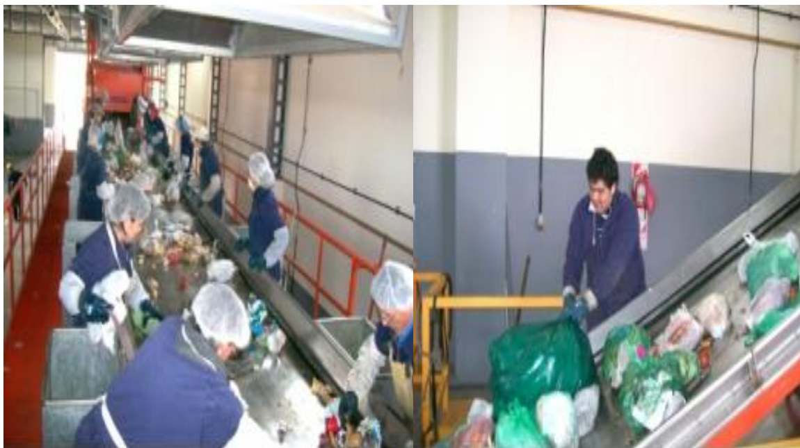
Figura 3.39 Planta de tratamiento de RSU de Esquel y Trevelin, con separación manual.
