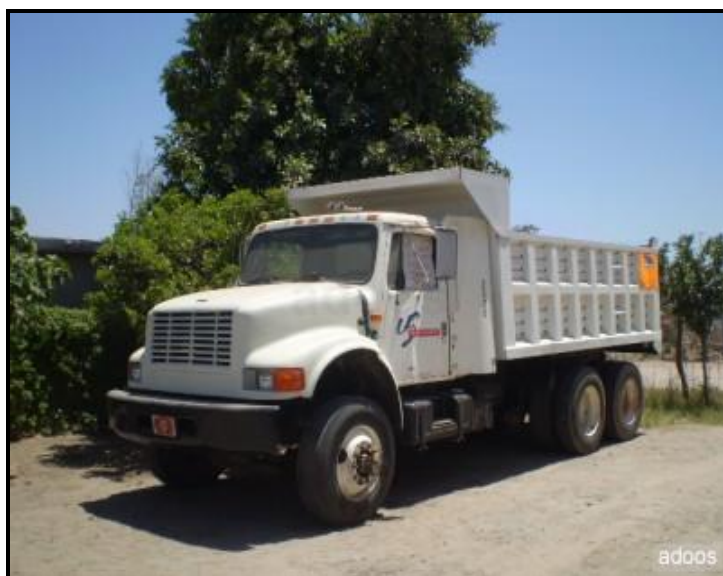
Figura 3.6 Camión de volteo de 14 m 3 , marca internacional.
