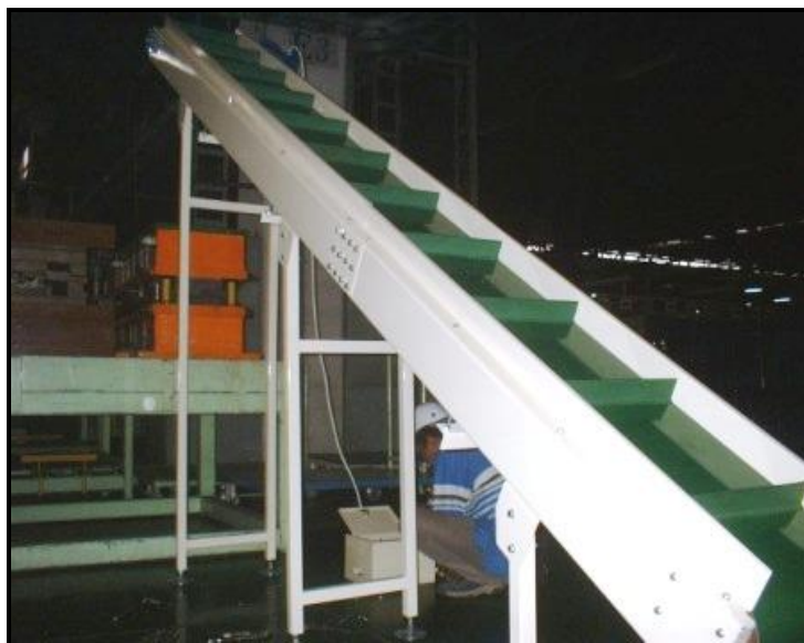
Figura 3.33 Banda transportadora de cajones chicos marca Moveyor.
