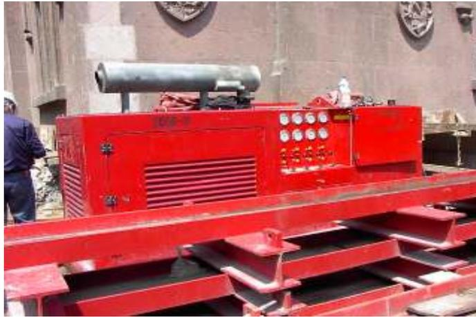
Figura 43. Generador hidráulico usado en el movimiento de la casa para operar equipos hidráulicos.
