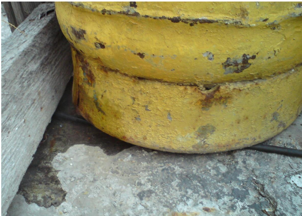
Figura 5.21: Derrame de Gas LP desde un cilindro de uso domestico con capacidad de 30 kg.
