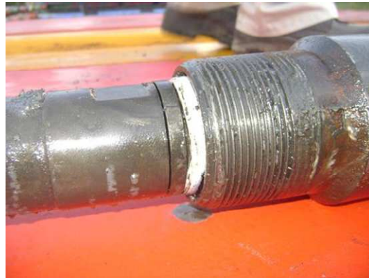
Figura 1.21. Camisa CD 6000 Perfil "BX" y Bomba SMART de 2 7/8", Pozo Samaria 162-B. 49
