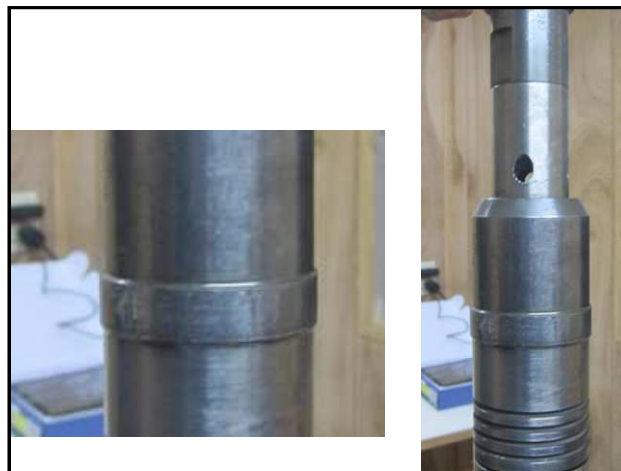
Figura 1.22. Bomba Jet recuperada del pozo Samaria 162-B. 49
