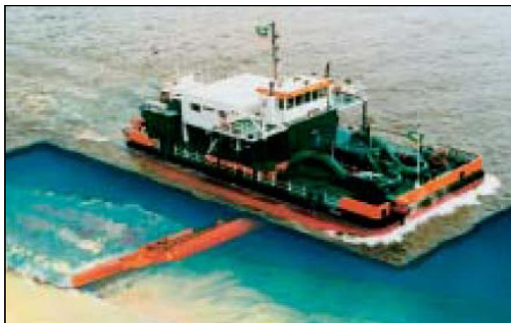
Imagen 2.4 Draga por inyección de agua. Fuente: Manual de equipos de dragado.
