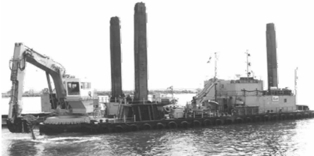
Figura 4. Dragas estacionaria mecánica con retroexcavadora.
