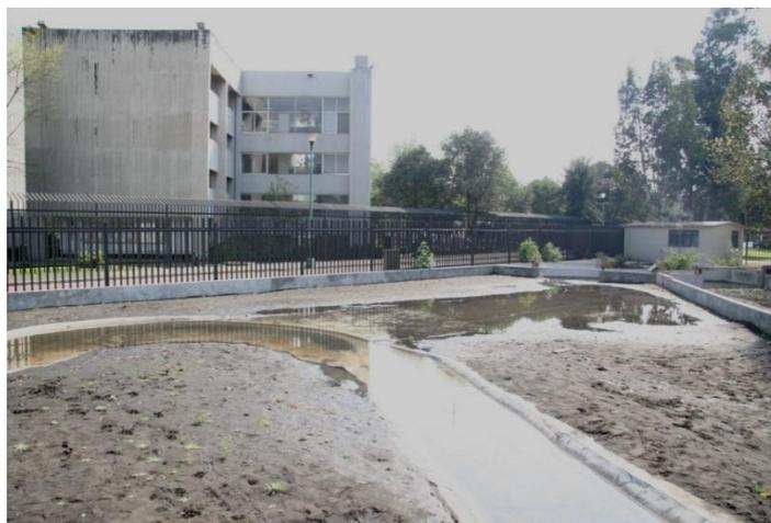
Fig 6.6 Modelo con un gasto de 400 m³/s
