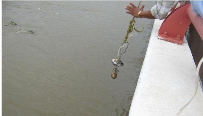
Fig 5.5 Medición de las velocidades con molinete.
