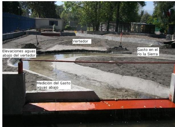
Fig 6.1 Modelo Hidráulico Censo.
