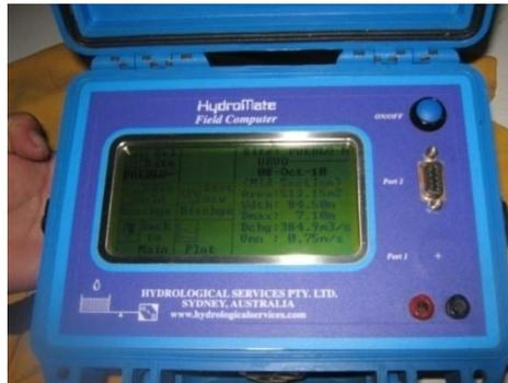
Fig 5.2 Aparato de medición de gasto mediante el aforo de las velocidades en dovelas.
