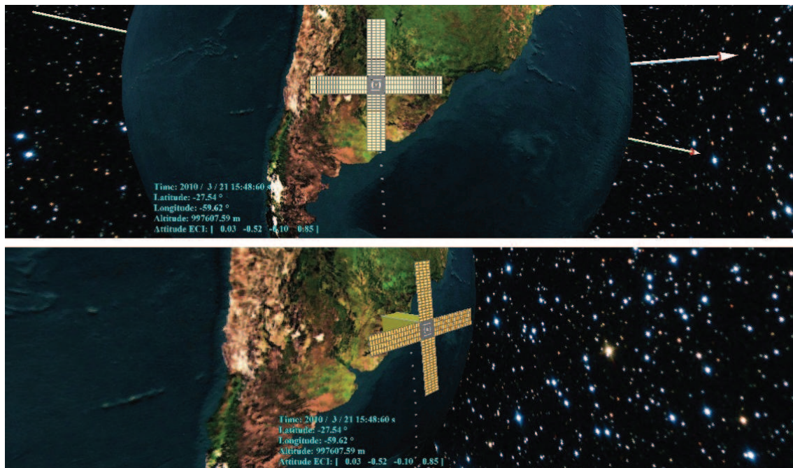
Figura 8.9: Visualización del comando de apuntamiento hacia el nadir terrestre en diferentes perspectivas.
