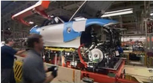
Imagen 4.20. Unión del tren de potencia con el chasis terminado
