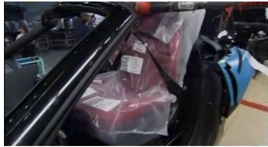
Imagen 4.19. Instalación de asientos
