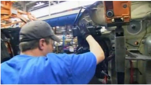
Imagen 4.18. Instalación de las líneas de frenado
