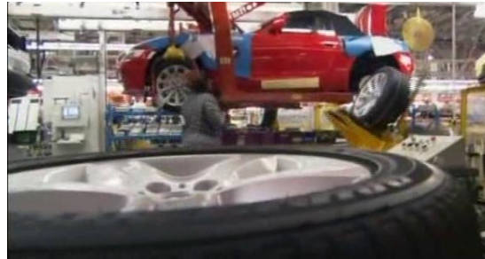
Imagen 4.21. Instalación de llantas
