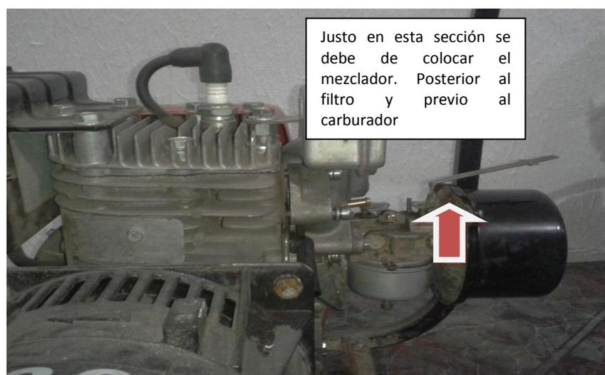
**Figura 4.15** Lugar en el que se debe de colocar el mezclador biogás-aire para la conversión
