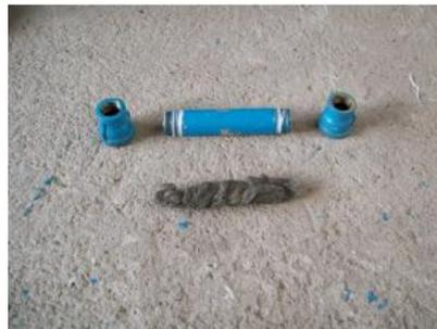
*Figura 4.11 Componentes de la válvula anti retorno (Juárez, 2012)*
