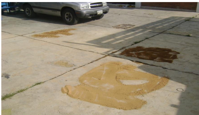
Fotografía 1 Secado y cuarteado del material a compactar
