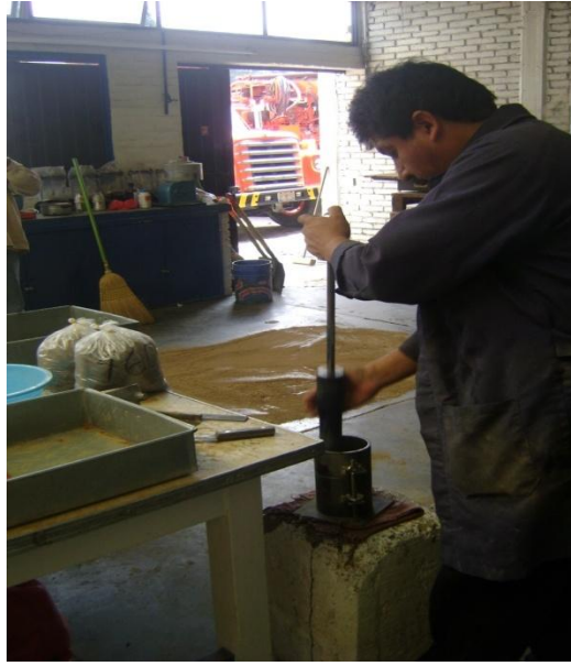
Fotografía 10 Compactación del material con el pisón
