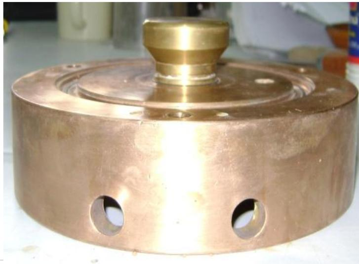
Fotografía 3 Cabezal de latón diseñado para las compactaciones de las probetas
