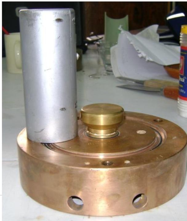
Fotografía 5 Molde tipo caña para la elaboración de probetas y base de cámara triaxial con cabezal de latón diseñado para compactación
