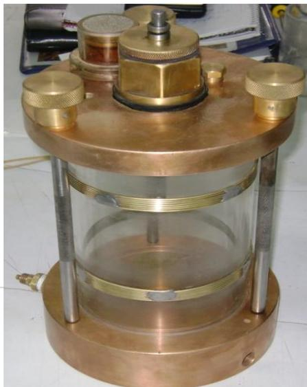
Fotografía 1 Cámara triaxial utilizada para la resistencia al esfuerzo cortante
