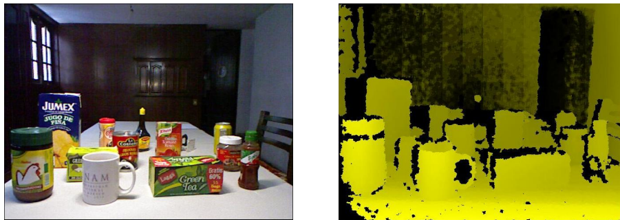
Figura 10. a) Imagen RGB, y b) información de profundidad. Los sistemas actuales capturan imágenes con una resolución de 640x480 a 30 cuadros por segundo. Los píxeles negros en la imagen de la derecha no tienen valor de profundidad, debido principalmente a oclusión, máxima distancia, al material o ángulo relativo de la superficie.
