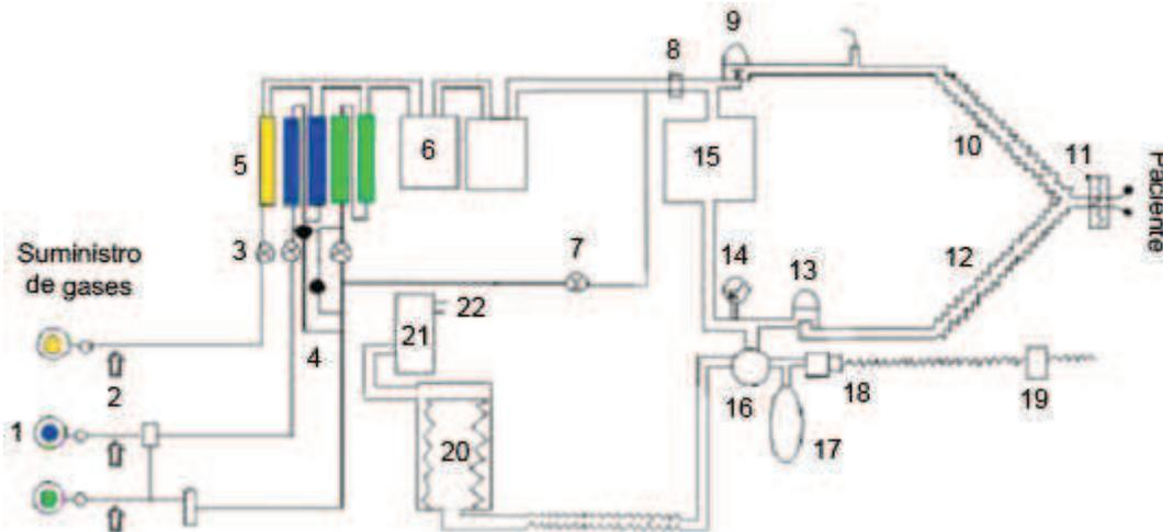
Imagen IV.2.7.1.- Circuito neumático del sistema de la máquina de anestesia [e]
