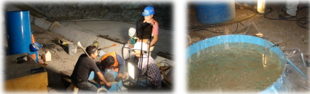
Figura 3.8 Calas volumétricas en el material 2
