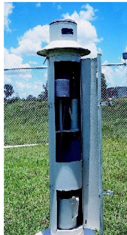
**Figura 2.1.** Pluviógrafo
