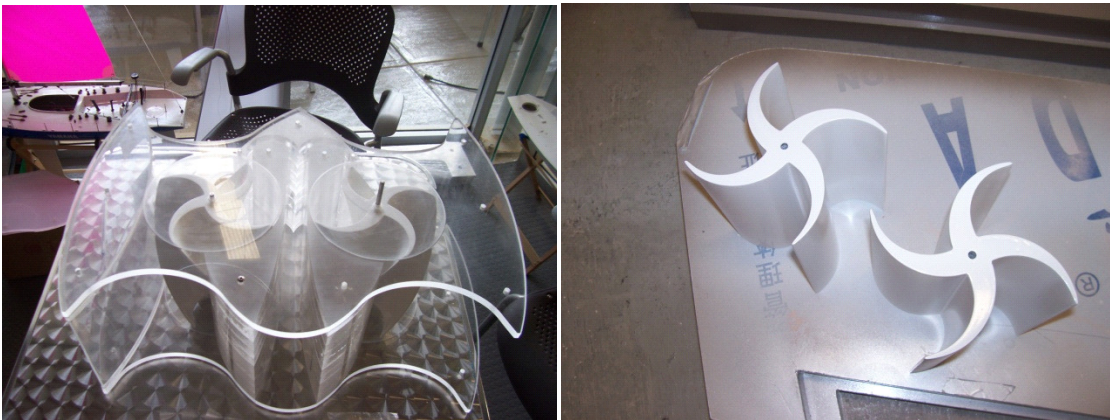
Figura 5-10 Dispositivo terminado, concentradores circulares, rotores rectos y helicoidales.
