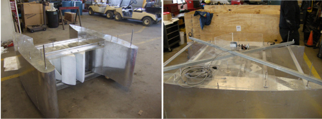
Figura 5-16 Hidrogenerador IMPULSA de 240 W
