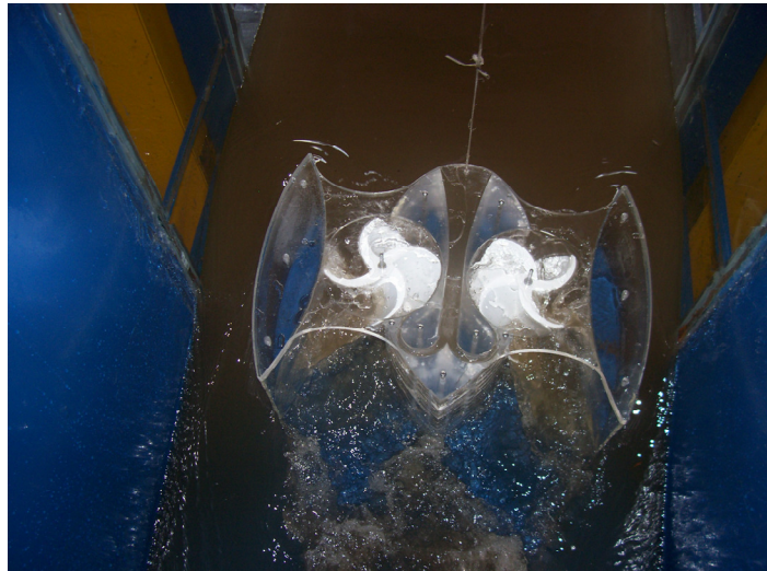
Figura 4-22 Prototipo inicial con concentradores circulares.
