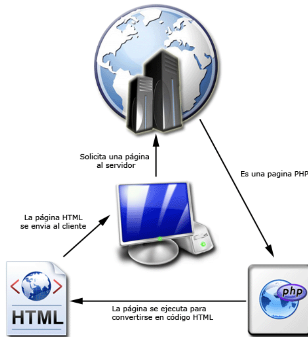
Figura 2.3.1 Diagrama de funcionamiento de PHP.
