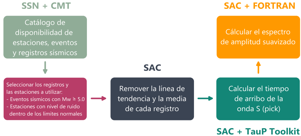
Figura 4. 4 Secuencia seguida desde la selección de los datos hasta la obtención del espectro de amplitudes de cada uno de los registros, indicando la herramienta utilizada para su realización.
