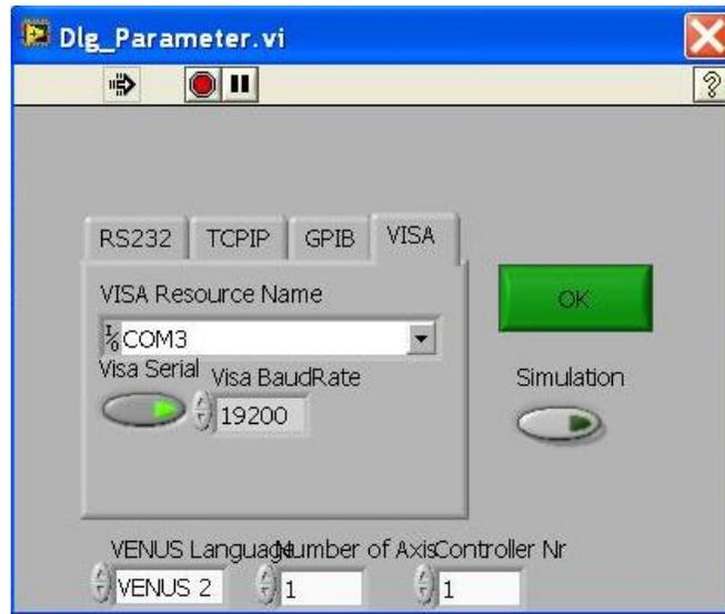
*Figura 4.2 Interfaz gráfica para la configuración de conexión de la platina lineal micrométrica.*
