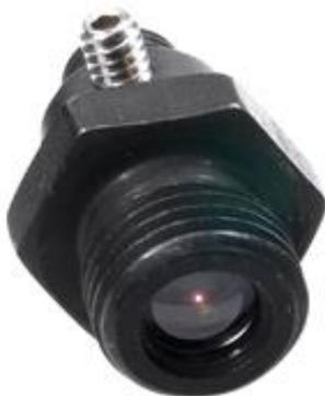
**Colimador 74-VIS.** Lente óptica de acoplamiento de Ocean Optics, cuenta con una lente BK-7 adecuada para el rango espectral VIS-NRI. Estos sistemas de un solo lente tienen la desventaja de la aberración cromática, debido a la dispersión o variación en el índice de refracción con la longitud de onda [11].
