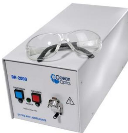
**Fuente de luz blanca de deuterio y halógeno-tungsteno.** Fuente modelo DH-2000, cuenta con dos lámparas las cuales son combinadas continuamente en un solo recorrido óptico, para obtener un rango espectral UV-VIS-IR de 215 a 1700 nm. Cuenta con la configuración de trabajar con una sola de las fuentes [11].
