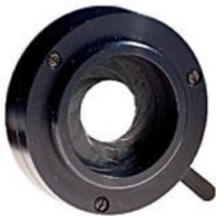
**Diafragma Iris.** Se utilizan para limitar la cantidad de luz transmitida, mediante el control del ancho del haz que pasa a través de él, mediante una palanca que ajusta la apertura en un rango de 1-30 mm de diámetro [10].
