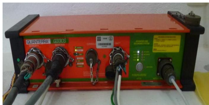
Figura 15 Registrador-digitalizador Quanterra Q330S
