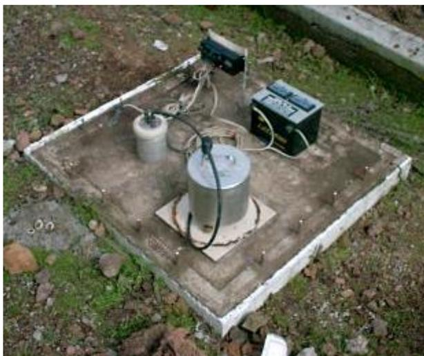
Figura 9 Sismógrafo GEOS de periodo corto
