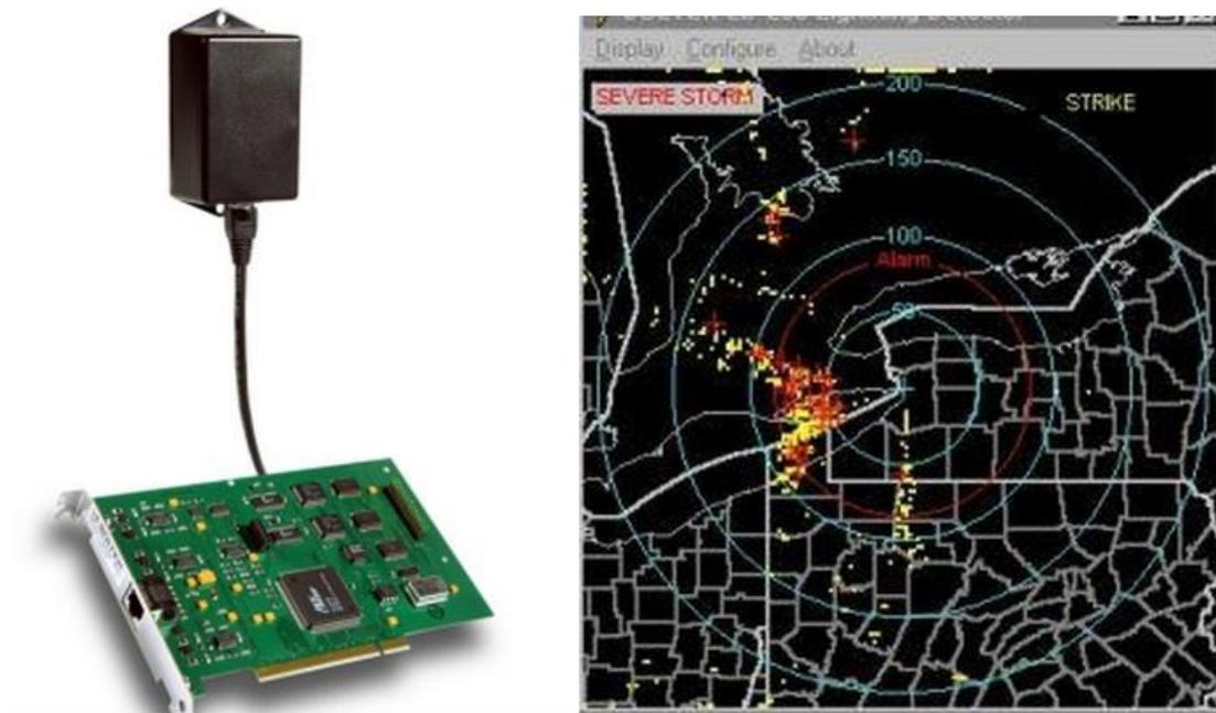
Figura 41 Detector y gráfica de tormentas de equipo Boltek.
